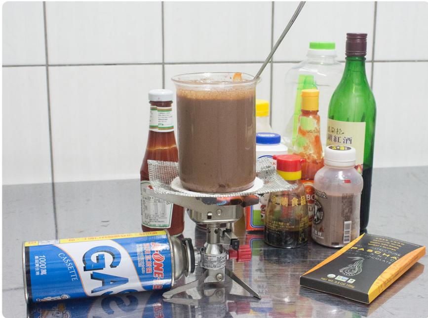
將汙染物各取適當份量後，加熱攪拌均勻融化，將白色布塊投入汙染物中。
