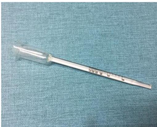
測量表面張力的方法有毛細管法、掛環法、威廉米平板法、旋轉滴法、旋滴法、最大氣泡法與滴體積法等，本次實驗是利用【毛細管酒精濃度計】來進行表面張力量測，這款酒精濃度計原就是以液體表面張力在毛細管高度來換算酒精濃度的量測器，利用這樣的器材可以快速得到各待測液體的表面張力值，其同濃度重複數值非常的接近，剛開始校正與游標卡尺的高度關係時產生的R2決定係數值為0.9884，非常接近於1準確度自然也相對的提高。
